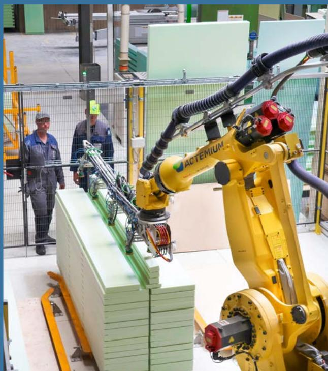
**Cette nouvelle phase de digitalisation coïncide avec notre augmentation de capacité pour la gamme CHEREAU Performance VIP qui, grâce à une technologie d'encapsulation de panneaux sous vide dans les modules de mousse, offre jusqu'à 25% de gain d'isolation et donc autant d'économie d'énergie pour nos clients.**
